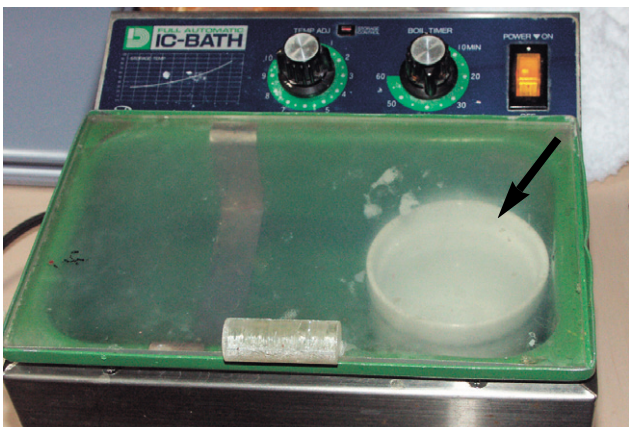
그림 4-12. 열가소성 플라스틱의 연화에 사용하는 항온 bath와 유리용기(화살표).
